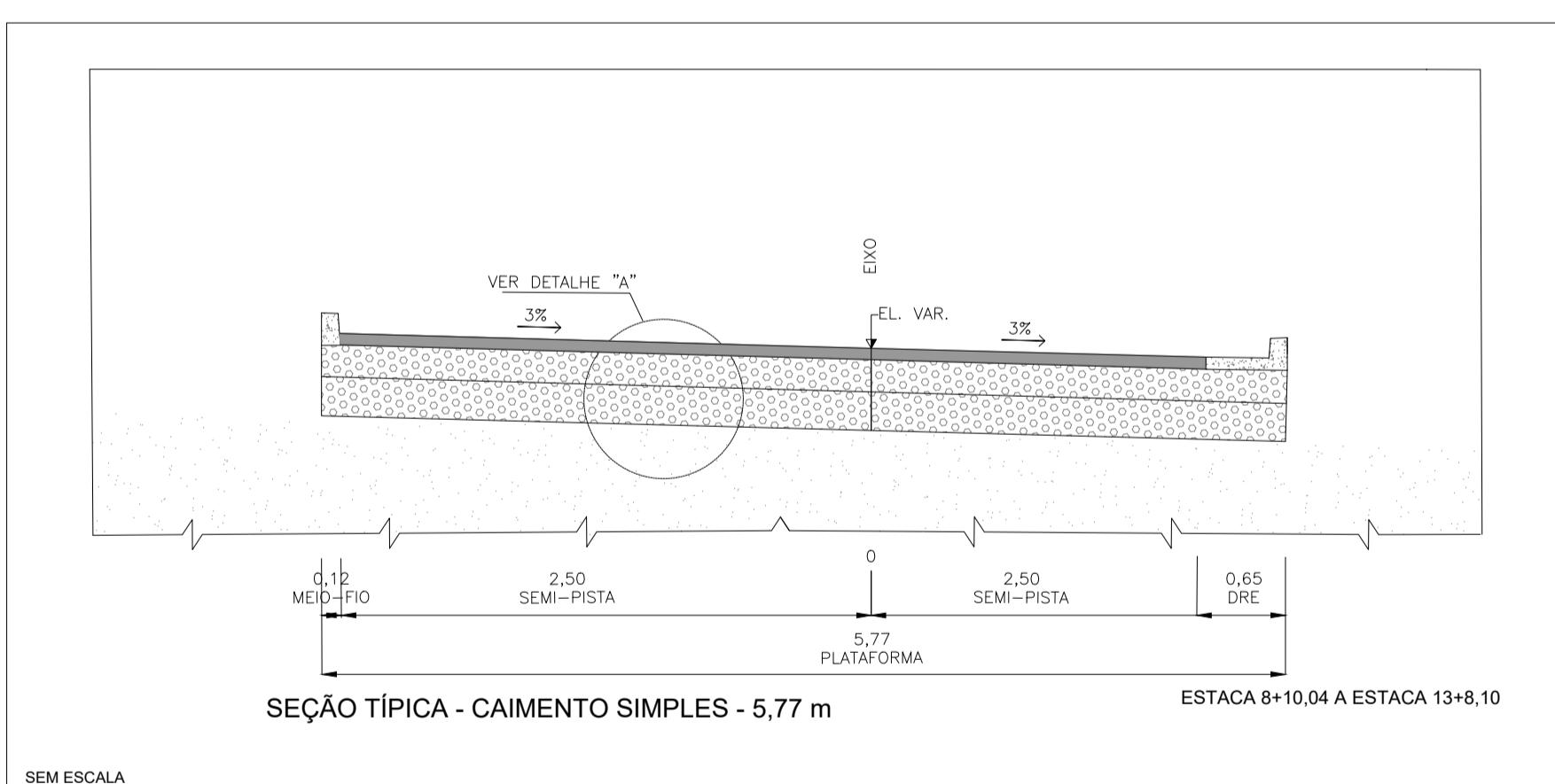
DETALHAMENTO DA SEÇÃO TIPO RECAPEAMENTO
